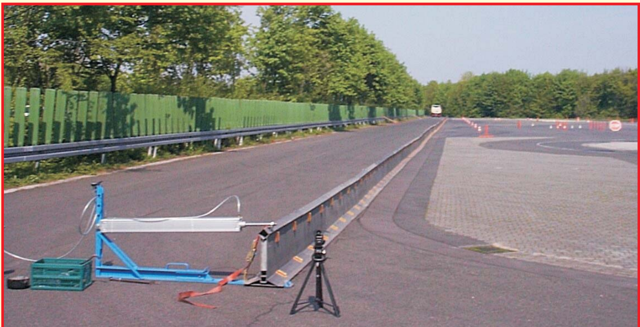
Die Prüfung zur Kipplängenbegrenzung (Ergänzung der TL - Transportable Schutzeinrichtungen 97) wurde bestanden
