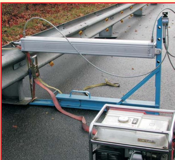
Die Prüfung der Kipplängenbegrenzung wurde bestanden
