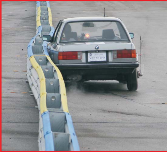
TÜV Süd: Geringste Querverschiebung bei der Anfahrprüfung
